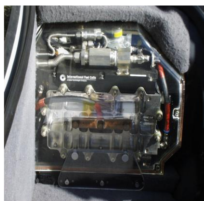
Figure 10 - La pile PEMFC utilisée en APU dans le prototype 750 (HyForum 2000)
