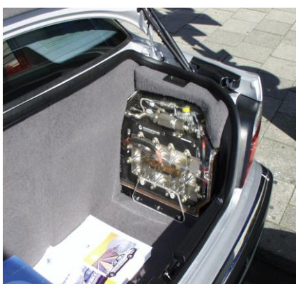
Figure 10 - La pile PEMFC utilisée en APU dans le prototype 750 (HyForum 2000)
