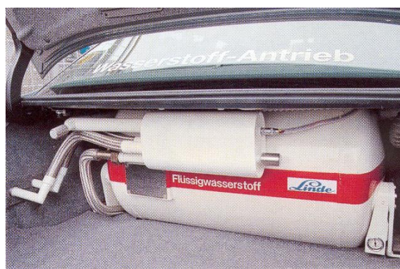
Figure 2 - Le réservoir d'hydrogène liquide occupait une partie du coffre
