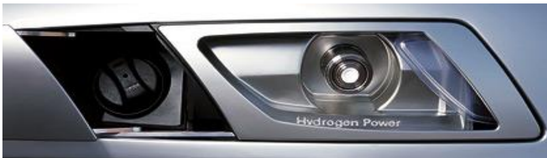
Figure 6 - Les embouts de remplissage en hydrogène et en essence
