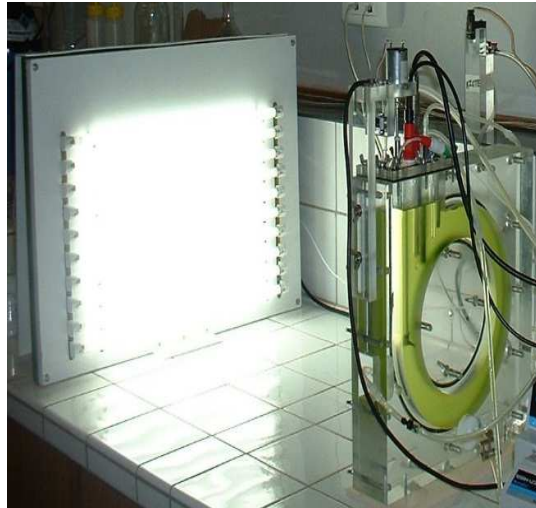
Figure 2 - Photobioréacteur d'étude pour la bioproduction d'hydrogène
