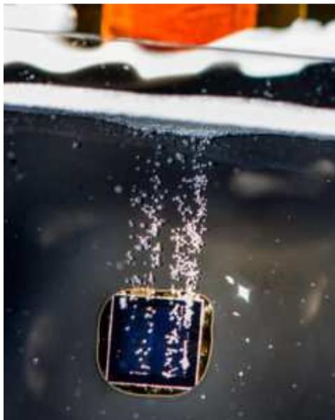
Figure 2 – Dégagement d'hydrogène du PEC du NREL ( 2017)
