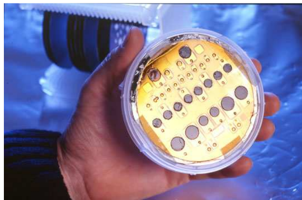
Fig. 3 - Ensemble de micro-piles à combustible (Source CEA)
