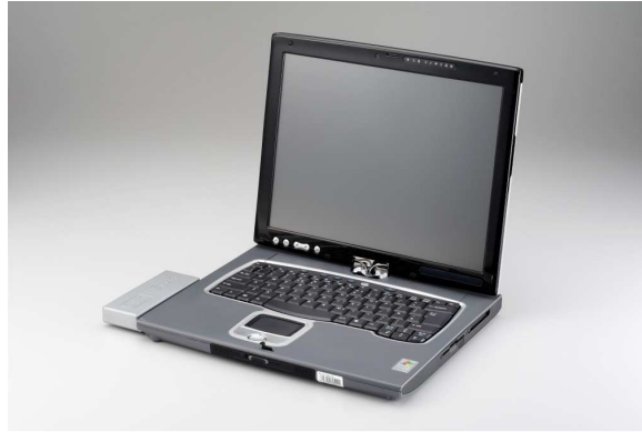
Figure 9 –Ordinateur AVC équipé du bloc d'alimentation Antig Tech . (sur la gauche (DMFC) (2006))
