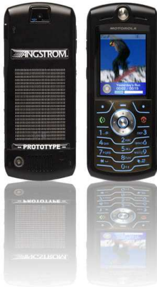
Fig. 1 – Prototype de téléphone cellulaire Motorola à micro-pile à combustible ( Angstrom ) intégrée et alimentée en hydrogène (2007)
