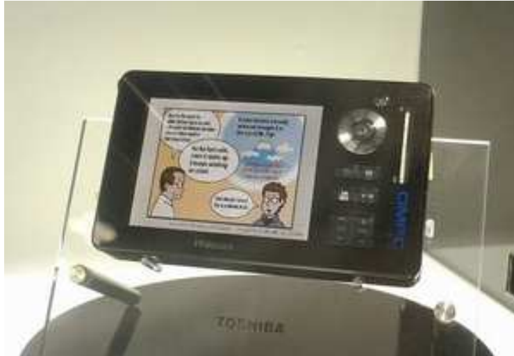
Fig. 5 – Baladeur Toshiba à pile intégrée (DMFC) (2007)
