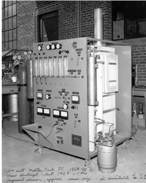
Figure 1 - Module MCFC de 100We fabriqué par Texas Instruments (1964)
