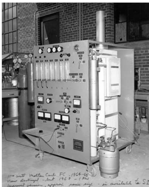
Figure 1 - Module MCFC de 100 W fabriqué par Texas Instruments (1964)
