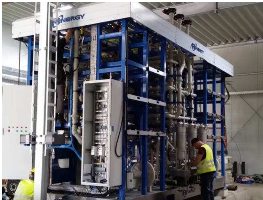
Figure 5 – Le module AFC/KORE de 240 kWe
