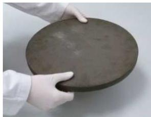
**Figure 3 - Galette à base d'hydruire de magnésium**
