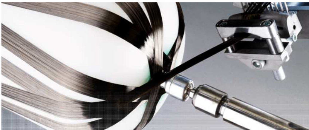
Figure 4 - L'enroulement filamentaire (document Xperion)
