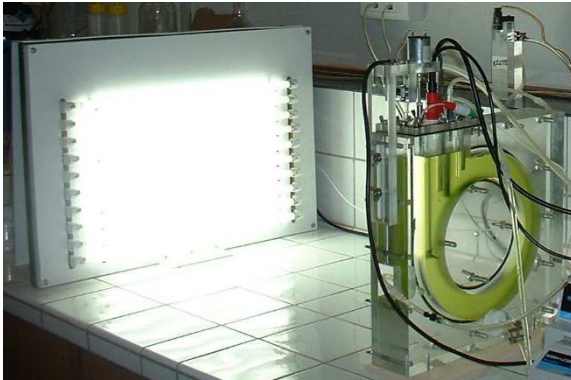
Photobioréacteur d'étude pour la bioproduction d'hydrogène
