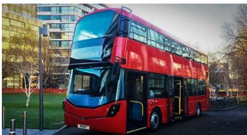
Le groupe d'Irlande du Nord a présenté à Londres une version à hydrogène de ses bus à double étage. Celle-ci combine à la fois une pile à combustible et une batterie. L'ensemble permet de propulser le bus en mode zéro émission et de proposer un plancher plat.
